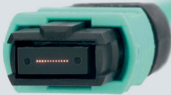
1 2 3 4 5 6 7 8 9 10 11 12 (Stecker-Stirnfläche und Pin-Position)
